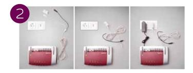
Das lange, graue Kabel verbindet Ihre FRITZ!Box mit der TAE-Dose. Verbinden Sie dazu das kurze Kabelende mit dem DSL-Adapter und stecken diesen in die "F-Buchse" der TAE-Dose. Das lange Kabelende stecken Sie in die Buchse "DSL/TEL" an Ihrer neuen FRITZ!Box. Das schwarze Kabelende bleibt frei.
